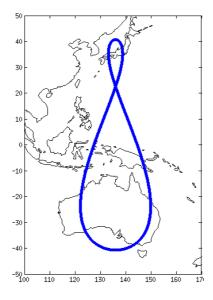
FIGURE 1: GROUND TRACK OF QZS-1 ORBIT.
