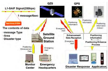
FIGURE 2: QZSS ALERT MESSAGING TRANSMISSION SYSTEM.
