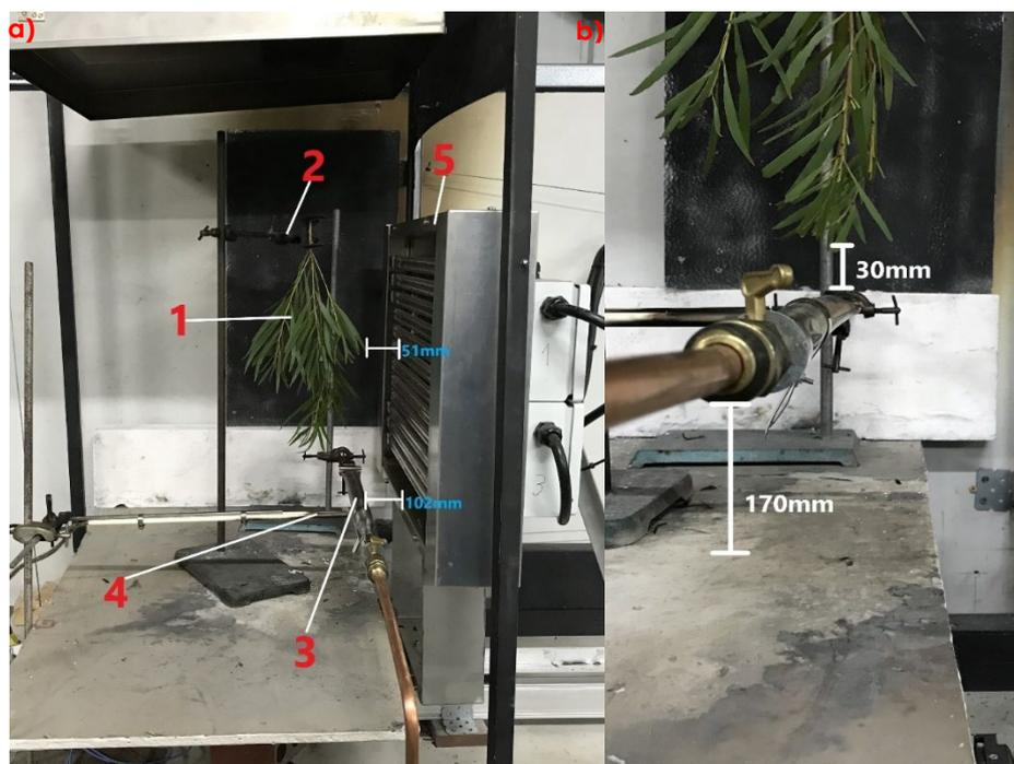
FIG. 3. EXPERIMENTAL DESIGN: a) HORIZONTAL ARRANGEMENT: 1) SAMPLE, 2) CLAMP, 3) PILOT IGNITER, 4) SPARK IGNITER, 5) RADIATIVE PANEL; b) VERTICAL ARRANGEMENT.
