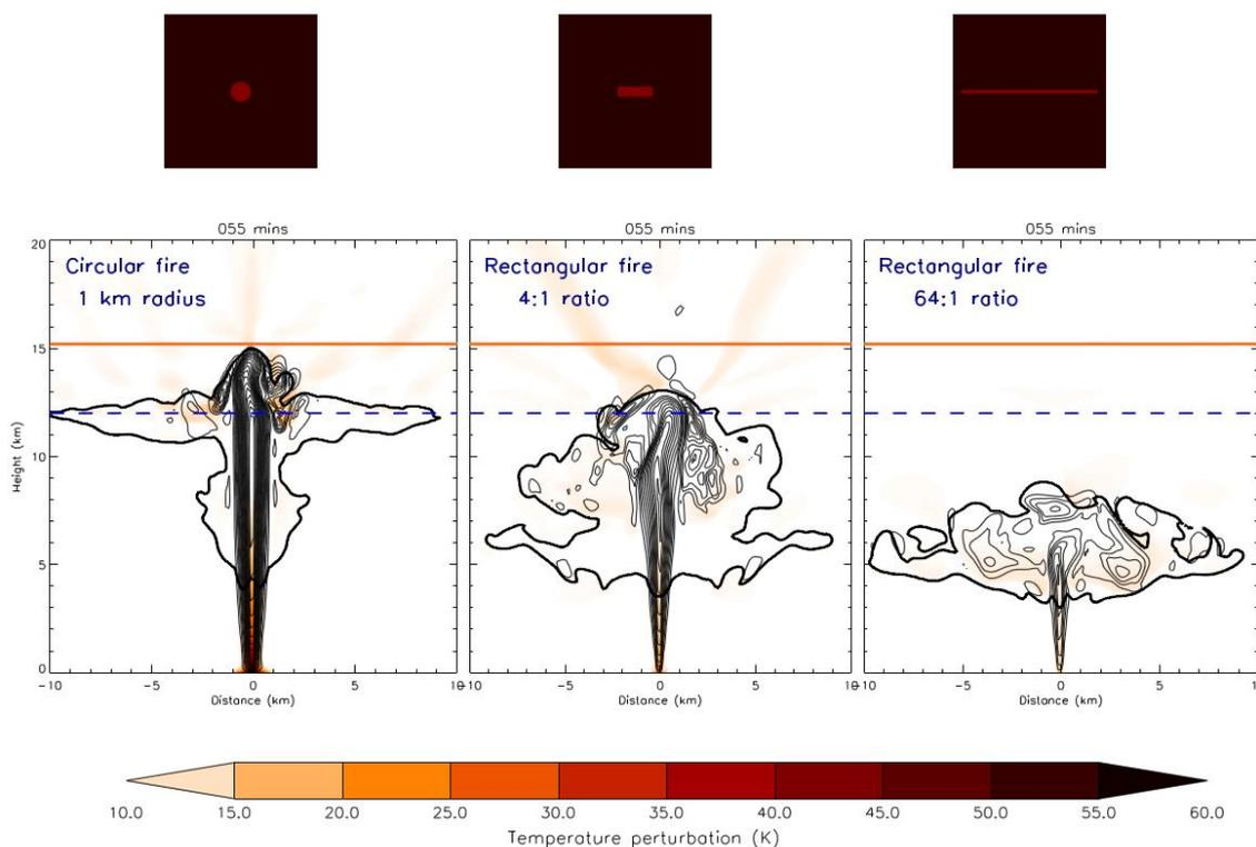
**FIGURE 4** – THE EFFECT OF THE SPATIAL CONFIGURATION OF SURFACE HEAT FLUX ON PYROCONVECTIVE PLUME DEVELOPMENT. THE FIGURES IN THE TOP ROW SHOW THE GEOMETRY OF THE HEAT FLUX. THE TOTAL ENERGY RELEASE IS THE SAME IN EACH CASE.
