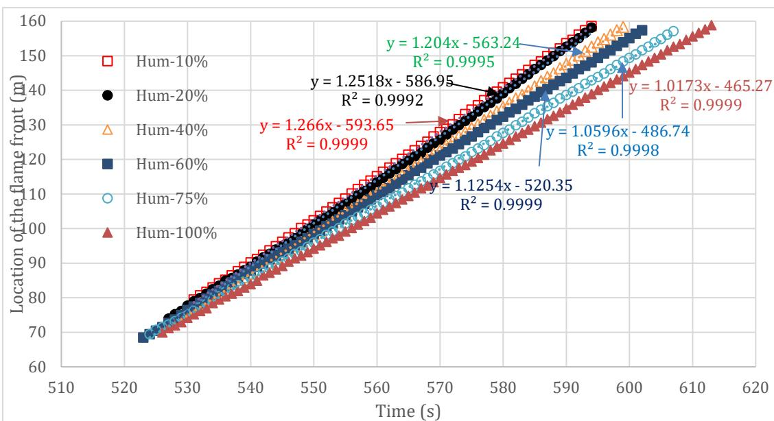
FIGURE 3 – FIREFRONT LOCATIONS VS TIME FOR CASES WITH GRASS HEIGHT OF 0.21M
