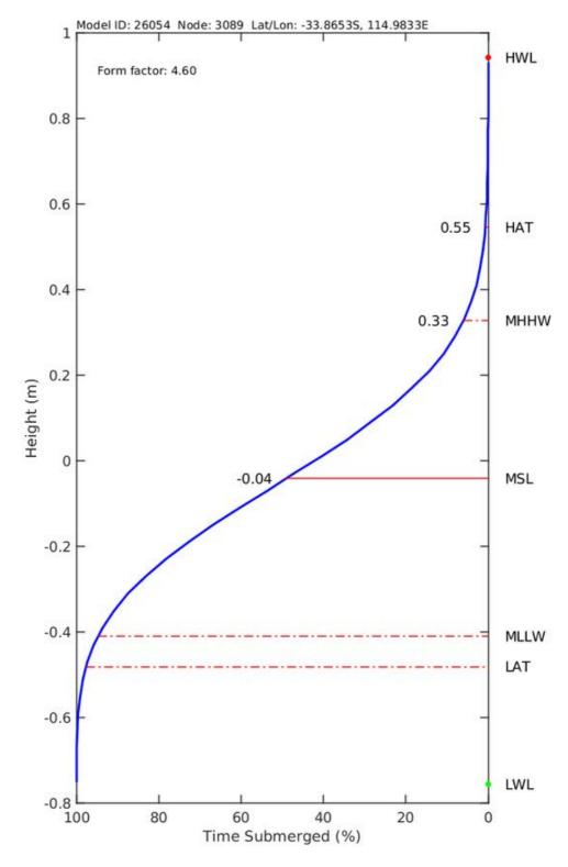
FIGURE 25. EXAMPLE SUBMERGENCE CURVE PLOT AVAILABLE FOR EACH COASTAL DATA POINT ON UWA/BNHCRC EXTREME SEA LEVEL WEBSITE. THE CURVE APPROXIMATES THE PERCENTAGE OF TIME THE SEA LEVEL WILL BE ABOVE VARIOUS LEVELS BASED ON NUMERICAL MODEL RESULTS.
