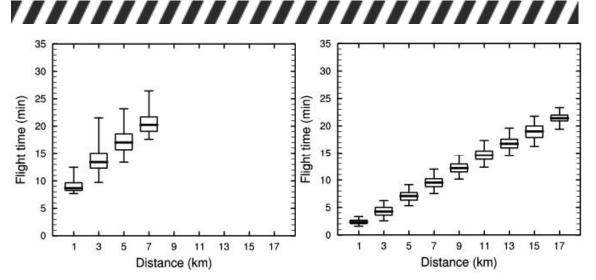
FIGURE 4. BOX AND WHISKER PLOTS OF FLIGHT TIMES FOR FIREBRANDS LOFTED BY THE TIME-VARYING PLUMES UNDER BACKGROUND WIND SPEEDS OF 5 (LEFT) AND 15 (RIGHT) M S–1. FLIGHT TIMES ARE BINNED ACCORDING TO THE DISTANCE TRAVELLED BY THE FIREBRAND, AT 2-KM INTERVALS. THE THICK LINE SHOWS THE MEDIAN FLIGHT TIME AND THE BOX SPANS THE INTERQUARTILE RANGE. WHISKERS REPRESENT THE 1ST AND 99TH PERCENTILE FLIGHT TIMES.
