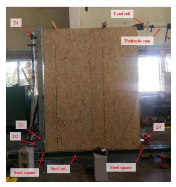
FIGURE 9: OSB TEST SAMPLE IN TEST RIG
